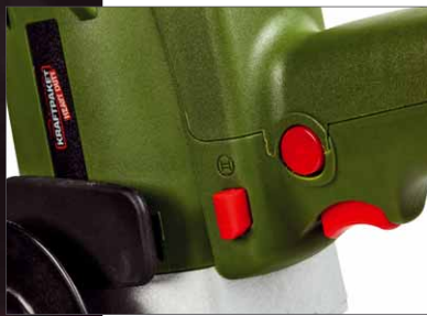
Wo beim Akkuschraber der Drehrichtungsschalter sitzt, findet sich an der Poliermaschine der sogenannte Komfortschalter. Damit lässt sich die voreingestellte Drehzahl in zwei Stufen anfahren. Das verhindert zusammen mit dem Sanftanlauf umherspritzende Politur
