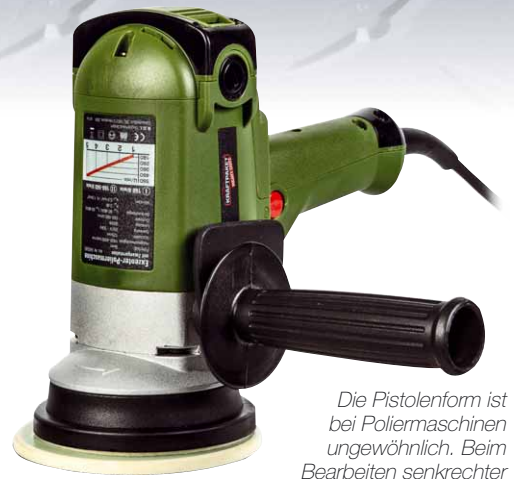
Wo beim Akkuschraber der Drehrichtungsschalter sitzt, findet sich an der Poliermaschine der sogenannte Komfortschalter. Damit lässt sich die voreingestellte Drehzahl in zwei Stufen anfahren. Das verhindert zusammen mit dem Sanftanlauf umherspritzende Politur
