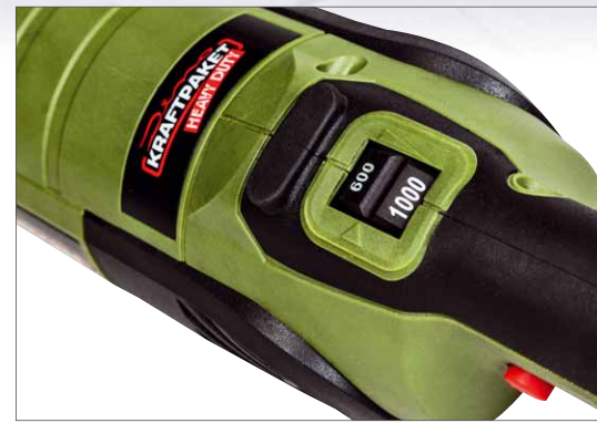
Die Arbeitsdrehzahl wird per Elektronik konstant gehalten. Sie lässt sich in 7 Stufen zwischen 600 und 3.000 Umdrehungen einstellen
